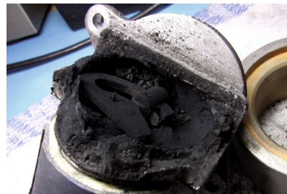
Hauptgrund für den Ausfall von AGR- und E-AGR-Ventilen ist Verkokung, verursacht durch periphere Probleme.
