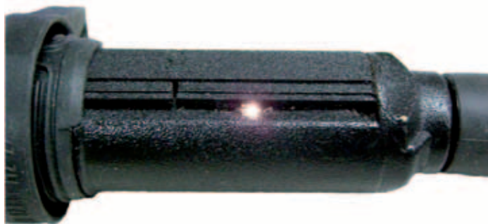
Die Isolation dieser Zündspule schlägt durch
