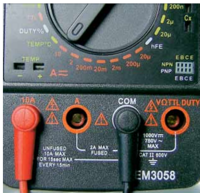
Korrektter Anschluss: Beim Messen der Stromstärke ist der maximale Messbereich ausschlaggebend. Im Bild sind dies 10 A.
