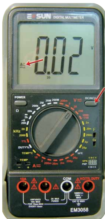
Das Umschalten zwischen Wechsel- und Gleichspannung geschieht mit dem Schaltknopf (rechter Pfeil) und wird klein im Display angezeigt (linker Pfeil).
